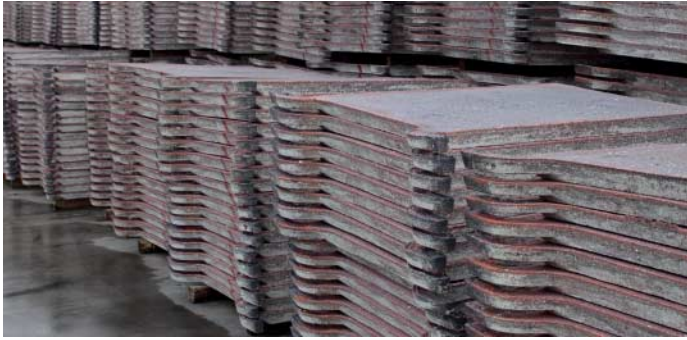
Die Anoden bestehen zu 99 Prozent aus Kupfer – im Rest stecken die noch wertvolleren Edelmetalle.
