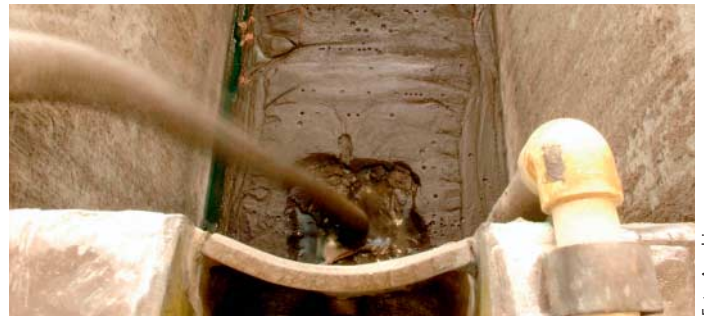
Im Becken bleibt der goldhaltige Anodenschlamm zurück. Insgesamt gewinnt Aurubis von den rund 40 Stoffen im Handy 25 zu über 90 Prozent zurück.
