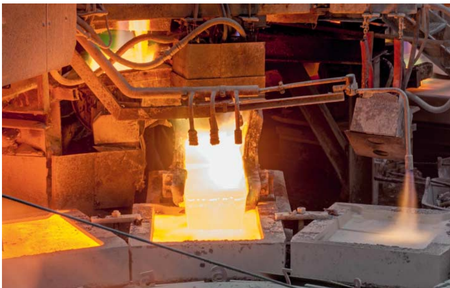
Das Anodengießrad: 1200 Grad heißes Kupfer fließt in vorgeheizte Formen und wird in Wasserbecken gekühlt.
