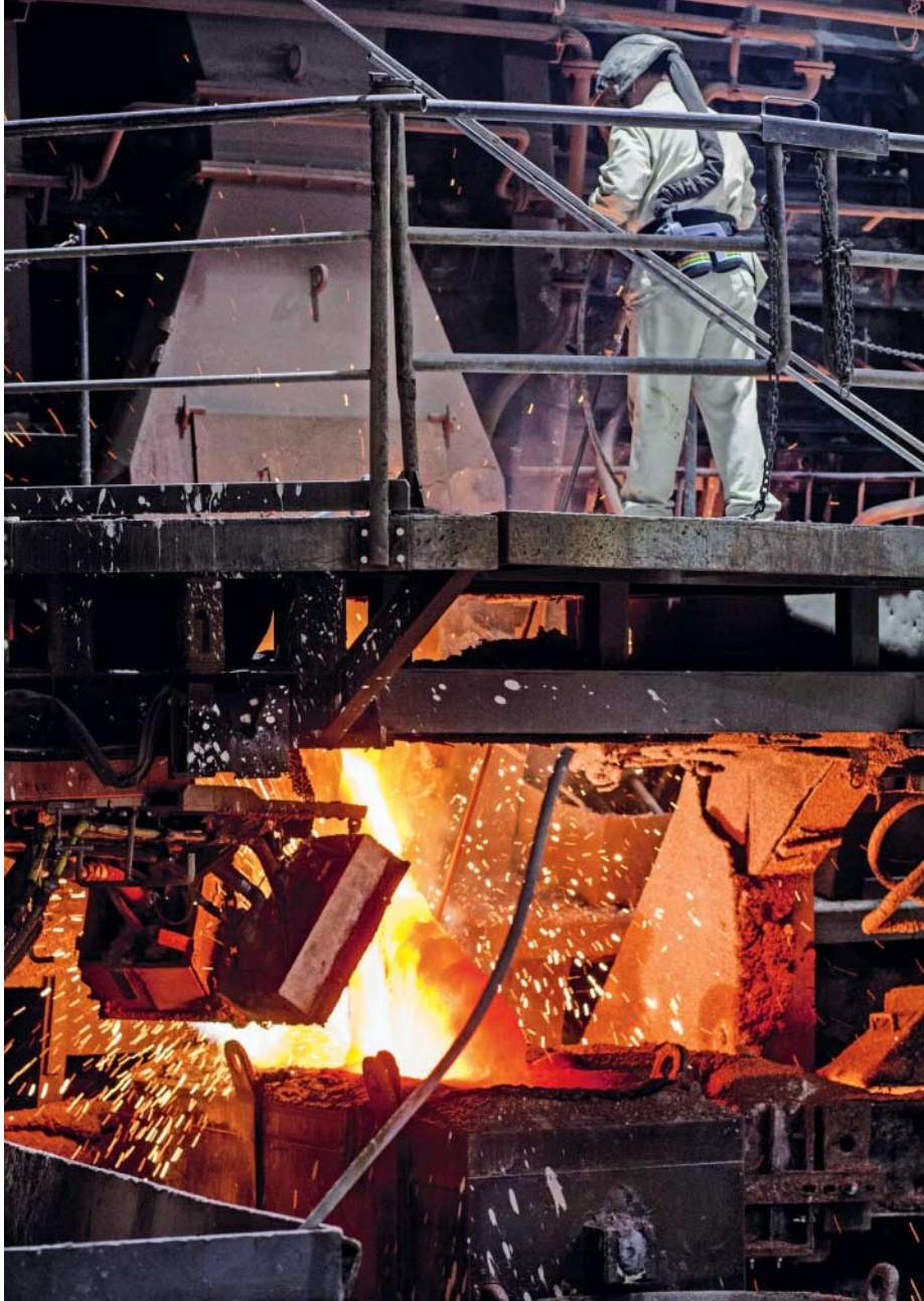
In der Gießhalle brennt ein Arbeiter mit einer Eisenlanze einen Kanal durch zu früh erstarrtes Kupfer frei.
