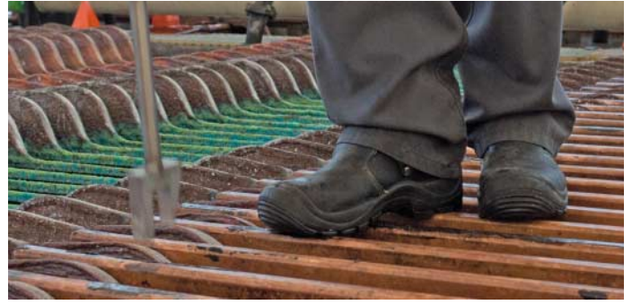
In der Elektrolyse-Halle kontrollieren „Entstörer“ den Abstand zwischen Anoden und Kathoden und verhindern Kurzschlüsse.
