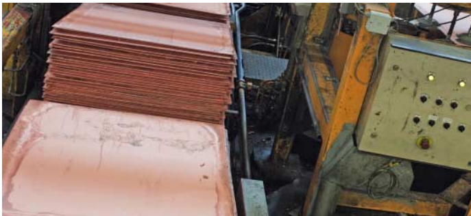
Die Kathoden nach der Elektrolyse: Sie bestehen zu 99,995 Prozent aus Kupfer und können nun an der Londoner Börse gehandelt werden.
