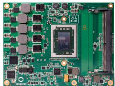
AMDs neue Embedded-APU-Familien G I und G J sind pinkompatibel zum „Merlin Falcon“ auf diesem COM-Express-Board von Congatec.
