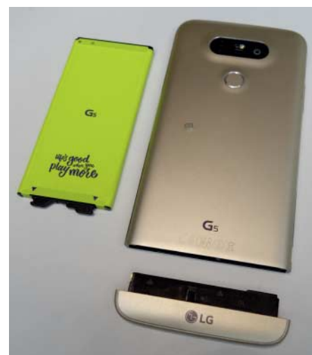
Das LG G5 lässt sich auseinanderbauen. So kann man zusätzliche Hardware-Module andocken.
