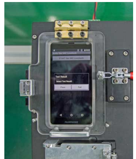
Jedes einzelne Display-Modul wird sofort getestet.
