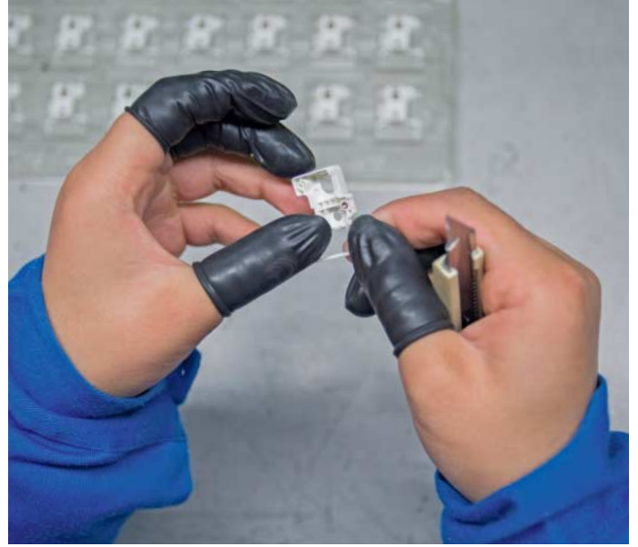
Eine Arbeiterin kontrolliert das Gehäuse des Kamera-Moduls und schneidet überstehenden Kunststoff weg.
