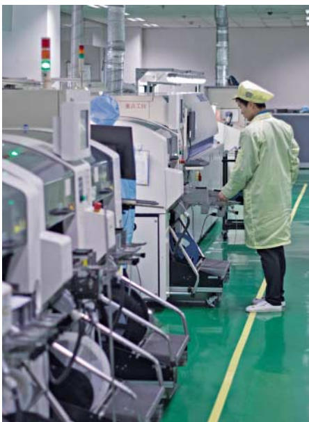
Das Fairphone-Mainboard wird komplett automatisch bestückt, ...
