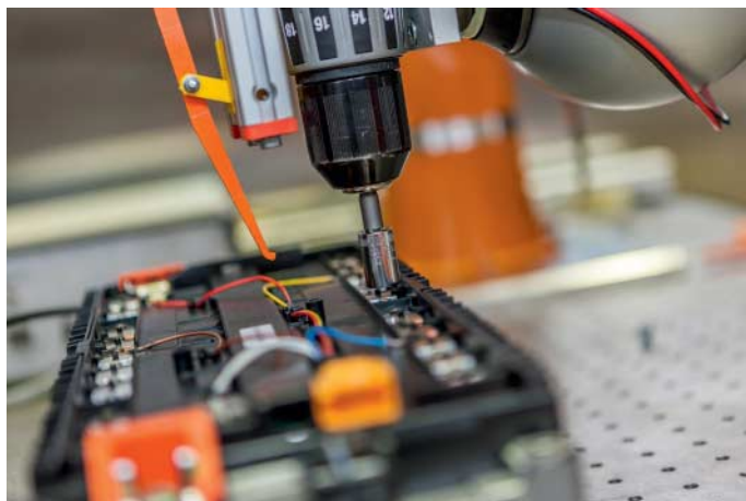
Robotergestützte Demontage einer Elektrofahrzeug-Batterie
