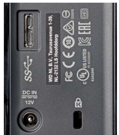
Wer Angst vor dem Diebstahl seiner externen Festplatte hat, schließt sie mittels Kensington-Lock fest.
