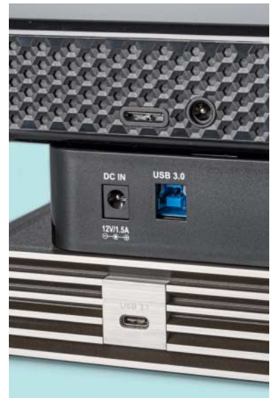
Drei verschiedene USB-Buchsen im Vergleich: oben Micro USB 3.0, USB Typ B mit USB-3.0-Erweiterung in der Mitte, Typ C unten.
