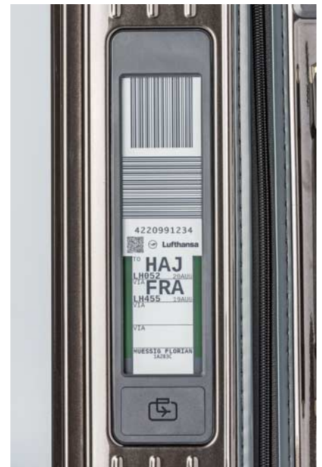
Das E-Ink-Display des Electronic Tag hat dasselbe Format wie der Aufdruck auf Gepäckanhängern aus Papier und sitzt hinter einer stabilen Scheibe aus Gorilla-Glas.
