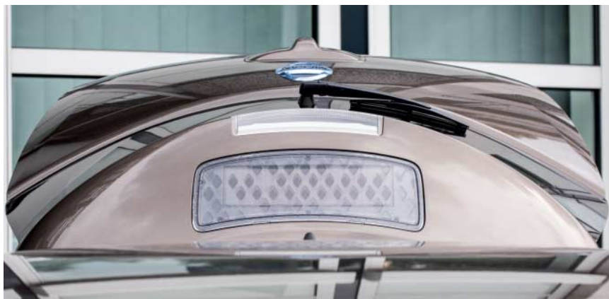
Der Solarspoiler in der Heckklappe des Leaf ist ein kostenpflichtiges Zubehör. Er speist allerdings nur das 12-Volt-Bordnetz.
