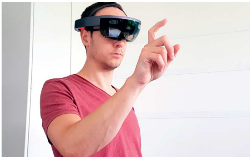
Das HoloLens-Windows steuert man per Sprache, Kopfbewegung und zwei einfachen Handgesten. Wischbewegungen kennt die Brille (noch) nicht.
