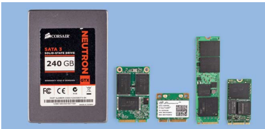
Im Vergleich zur 2,5-Zoll-SSD sind mSATA- und M.2-SSDs kleiner. mSATA-SSDs sind länger als WLAN-Kärtchen (daneben), rechts M.2-SSDs mit 8 und 4,2 cm.
