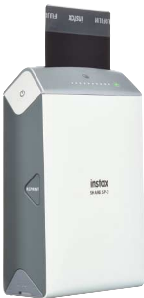
Der Mini-Drucker Instax Share SP-2 von Fujifilm empfängt Fotos per WLAN vom Smartphone und überträgt sie mit einem 800×600-Pixel-LCD auf einen kleinen Sofortbild-Film.
