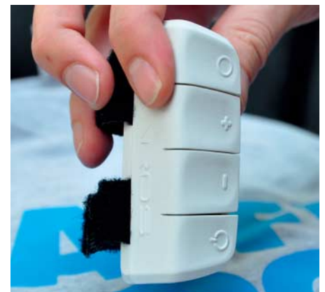
Das einzige elektronische Bauteil am Icaros: der Controller mit Positionssensor
