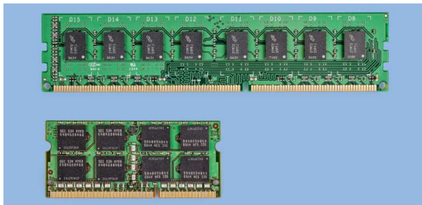
Ein SO-DIMM (unten) ist viel kleiner als ein normal großer Speicherriegel für Desktop-PCs.
