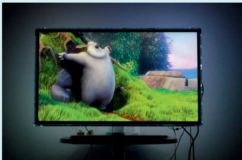
Die Kombi aus Kodi und Hyperion sorgt für ein flüssiges Lichterlebnis. Die Billig-Lichterkette streut allerdings stark, sodass die Farbfelder verlaufen.
