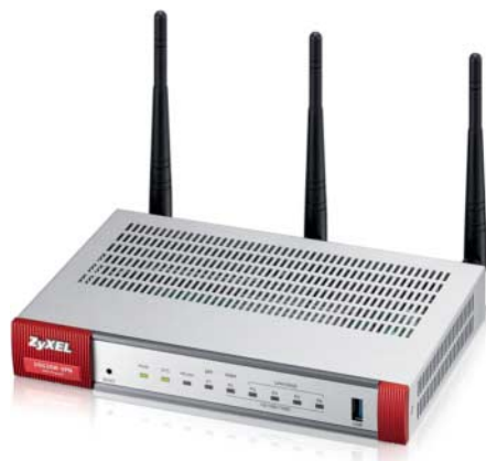
Der WLAN-Router Zyxel USG20W-VPN verbindet kleinere Firmen mit dem Internet und baut auch VPN-Verbindungen auf.
