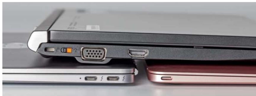
Das Toshiba Portégé Z20t-C bietet VGA- und HDMI-Ausgang. Beim HP EliteBook Folio und Apple MacBook finden Monitore an Typ-C-Buchsen Anschluss.
