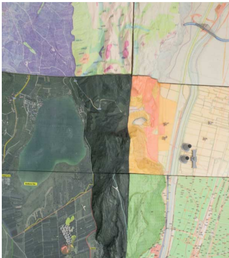
Das Modell zeigt sechs verschiedene von acht möglichen Oberflächenversionen. Die Kühltürme des Kraftwerks rechts wurden im FDM-Verfahren gedruckt und auf dem Modell platziert.
