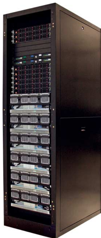
Das Object-Storage-System HGST Active Archive speichert bis zu 4,7 PByte pro Rack.
