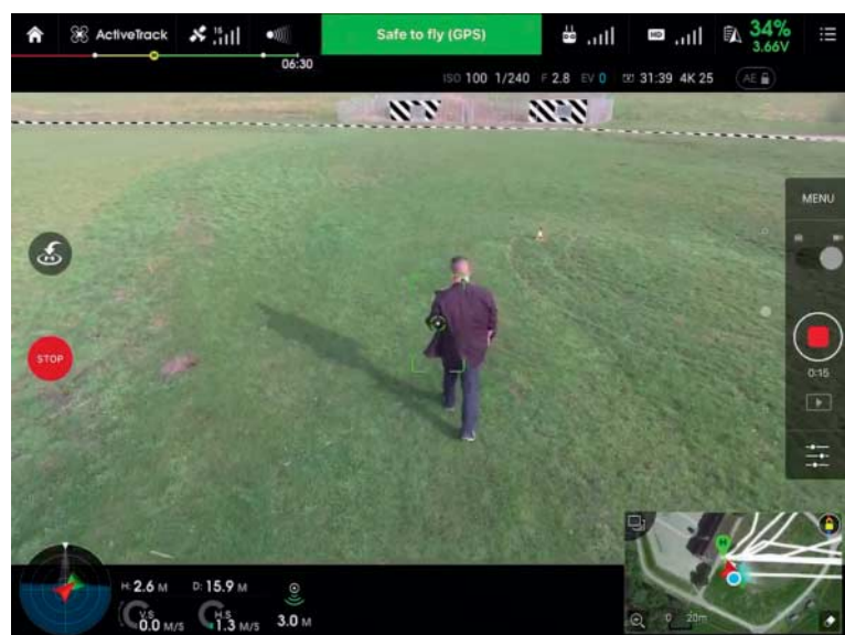
DJIs Quadrokopter Phantom 4 verfolgt automatisch ein zuvor in der DJI-Go-App markiertes Ziel.
