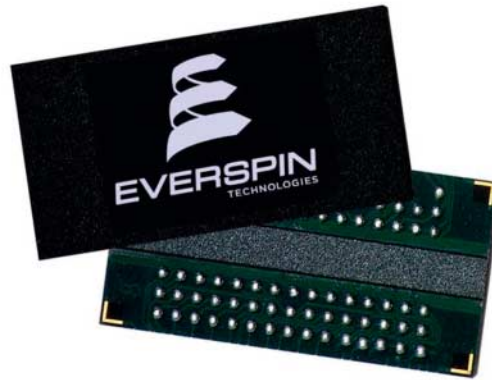
ST-MRAM von Everspin mit 256 MBit Kapazität eignet sich dank DDR3-Interface für neue Anwendungen.
