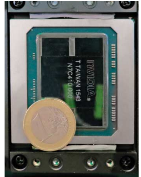
Der GP100-Chip ist riesengroß und schluckt bis zu 300 Watt.
