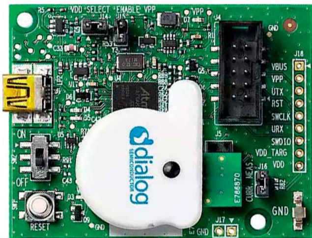
Das sparsame SmartBond IoT Dongle von Dialog – hier auf dem Adapterboard aufgesteckt – funkt Sensordaten per Bluetooth LE.
