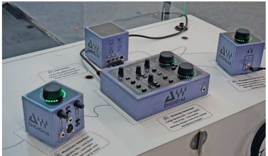
Bei den lustigen Würfelchen handelt es sich um die Desktop-Interfaces von DigiGrid. Sie werden über Ethernet mit Strom versorgt und sind Dante-fähig.
