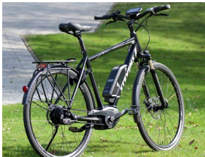
Das City-Bike „E-Caprile Luxe Gent“ von Stevens Bikes wird mit 250-Watt-Motor, 500-Wh-Akku, elektronisch gesteuertem Getriebe und Nyon-Bordcomputer ausgeliefert.
