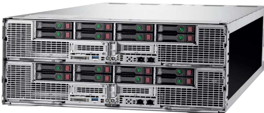
HPE Apollo 6500: HPC-Knoten für vier Xeons und 16 Tesla-Karten
