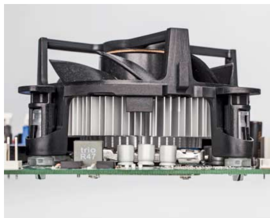
Bild links: Mit Hebelkraft presst der Halterahmen den Prozessor in die Fassung.
