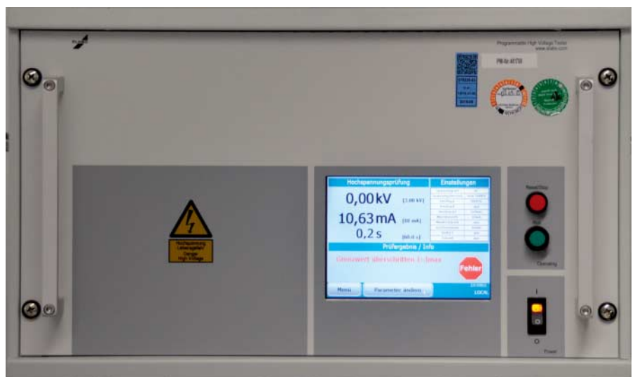
Beim Test der Spannungsfestigkeit geben die Prüfer 3 kV auf die Netzteile. Steigt die Stromstärke wie hier sprunghaft an, fällt das Netzteil durch.
