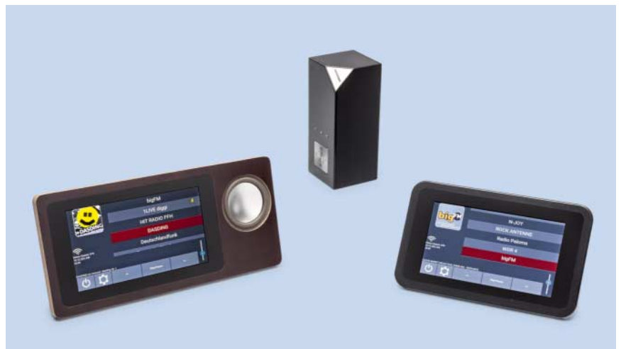
Internet-Radio in Holz und Plastik: Das Holz-Gehäuse mit integriertem Lautsprecher ist schicker und billiger als die Kunststoff-Variante mit Aktivbox, erfordert aber Zugang zu einer Fräse und etwas handwerkliches Geschick.
