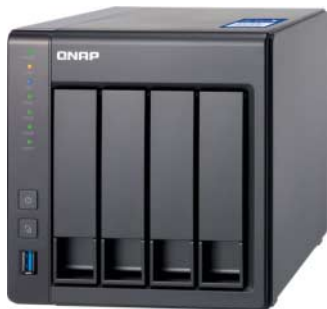
Der Netzwerkspeicher TS-431X soll über seinen SFP+-Port Daten mit knapp 1000 MByte/s liefern – wenn die Platten mitspielen.
