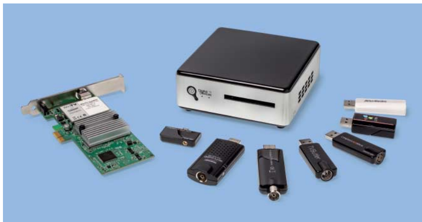
Für den TV-Empfang am Desktop oder Notebook stehen verschiedene Tuner-Varianten bereit: kompakte Empfänger als USB-Stick oder Ansteckmodul, PCI-Express-Karten oder Netzwerk-Tuner.
