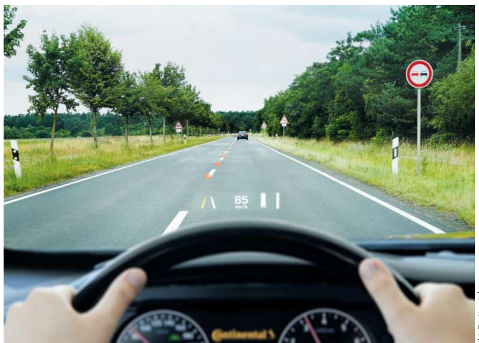
AR-HUD projizieren in einer zweiten Ebene Zeichen auf die Straße – hier wird die Mittellinie markiert, um den Fahrer zu unterstützen.
