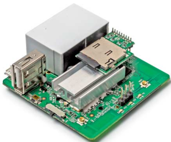
Platzsparende Konstruktion: Der SD-Slot sitzt über dem passiven Prozessorkühler.
