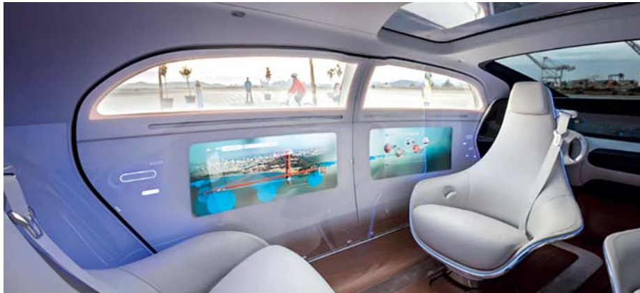
Beim autonomen Forschungsfahrzeug F 015 Luxury in Motion von Mercedes sind Seiten- und Rückwand mit Bildschirmen bedeckt.
