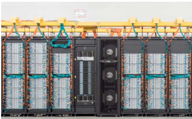
Der bisherige SuperMUC Phase 1 und Phase 2 leistet 5,7 PFlops im Linpack.
