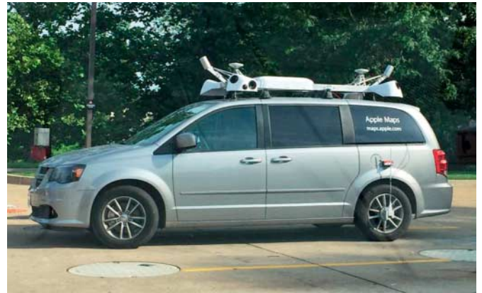
Eines von vielen Apple-Projekten rund um autonomes Fahren: Kamera-bewehrte Fahrzeuge nehmen Messdaten und Fotos auf, um detaillierte 3D-Karten anzulegen, die auch Straßenmarkierungen und Ampeln enthalten.
