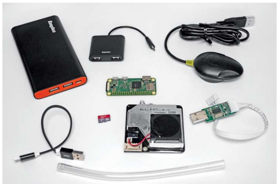
Die Komponenten für den mobilen Feinstaubsensor passen locker in eine kleine Kunststoffschachtel.
