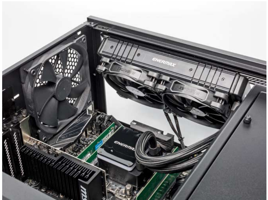
Zur leichteren Montage lässt sich das Halteblech im Dach mit dem Wärmetauscher zur Seite wegklappen.
