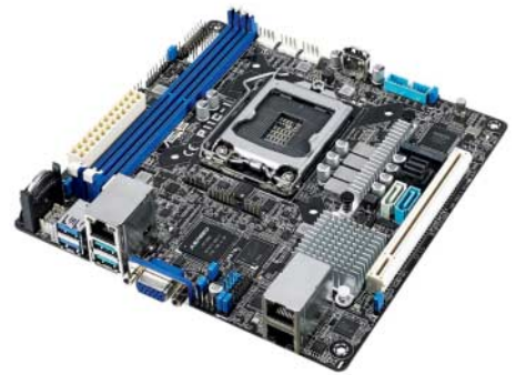
Das Serverboard Asus P11C-I hat nur Mini-ITX-Format, aber sechs SATA-6G-Ports und gegen Aufpreis Fernwartung.
