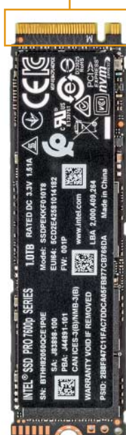
Schnelle PCIe-SSDs erkennt man an der einzelnen Kerbe an der Anschlussseite. Nutzen PCIe-SSDs nur zwei Lanes, haben sie meistens auch zwei Kerben.
