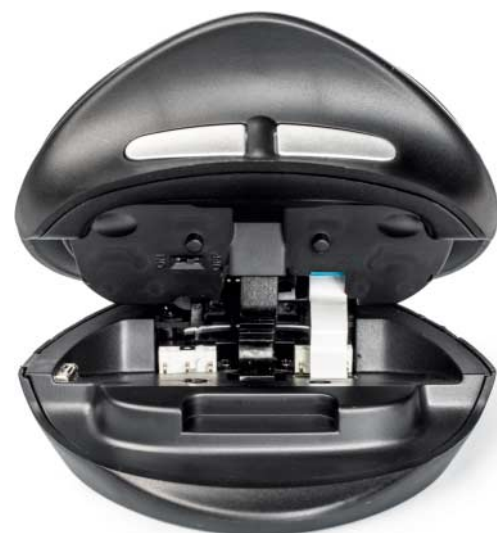
Die Klappmechanik der OysterMouse ermöglicht einen individuellen Neigungswinkel, ist aber auch wackelig.
