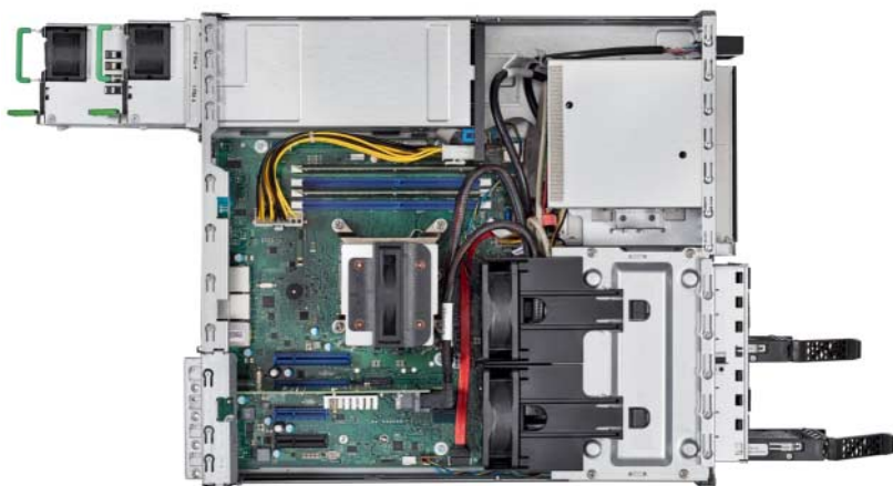
In den Primergy TX1320 M4 packt Fujitsu außer dem Xeon E-2100 noch ein redundantes Netzteil, einen SAS-Adapter und acht Festplatten oder SSDs.
