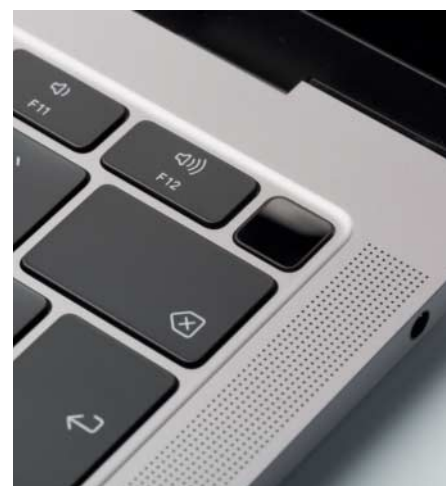
Der Einschaltknopf des neuen MacBook Air enthält einen Fingerabdruckleser für Touch ID.
