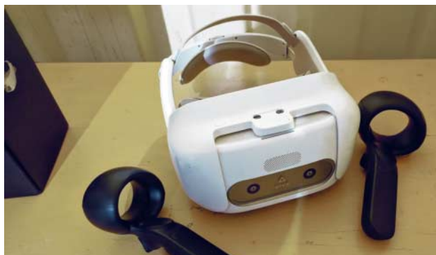
Die Handcontroller des VR-Headsets Vive Focus arbeiten mit Ultraschall.
