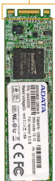
SATA-SSD im M.2-Format mit zwei Kerben an der Anschlussseite.
