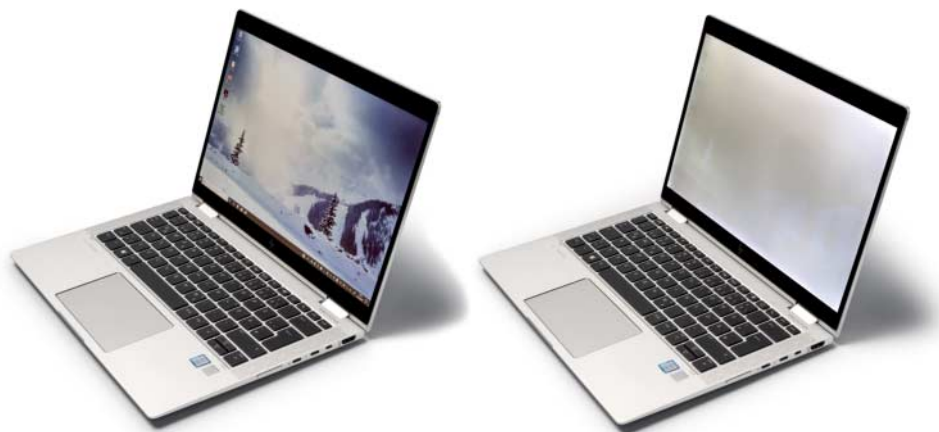
Der matte Touchscreen des HP EliteBook x360 1030 G3 wechselt auf Knopfdruck zwischen blickwinkelstabil (links) und stark blickwinkelabhängig (rechts).
