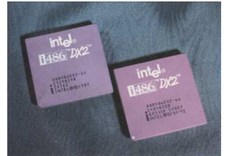
Irgendwie Erster: Die erste gefälschte CPU, die ihren Weg ins c't-Labor fand, war 1994 ein i486DX2-66, der aus einer 50-MHz-CPU gemacht wurde.
