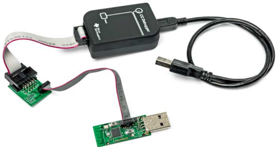
Zum Programmieren werden Stick und Programmer verbunden. Beide Geräte müssen an USB-Ports angeschlossen werden.
