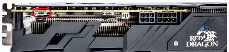
Per Schiebeschalter vor dem Slotblech wechselt man bei den Vega-Karten zwischen Quiet- und Performance BIOS. Letzteres lohnt allerdings kaum.
