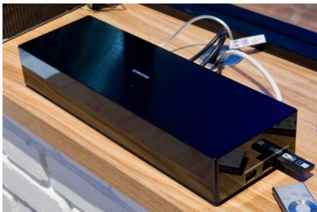
Die 8K-TVs von Samsung schließt man über die One-Connect-Box an. Sie kann ausgewechselt werden, wenn HDMI 2.1 fertig ist.
