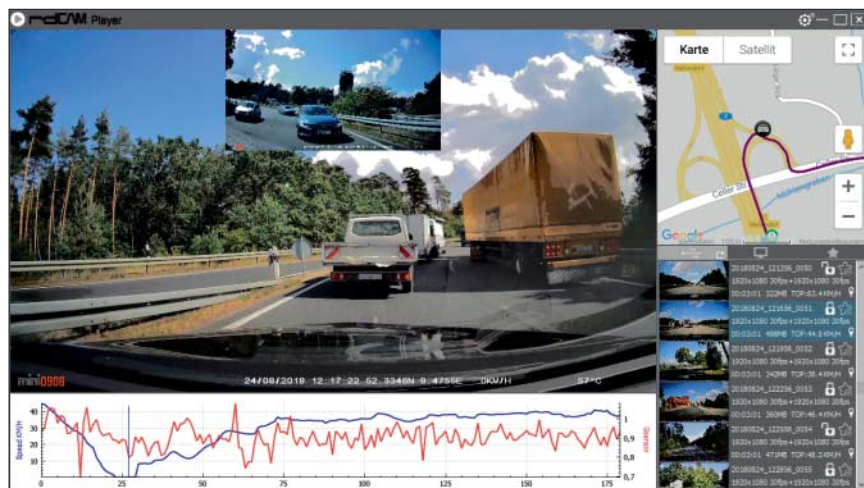
Einige Dashcams kommen mit Auswertungs-Software für den Rechner. Im Falle der iTracker mini 0906 zeigt sie Bilder der vorderen/hinteren Kamera an und blendet GPS-Informationen auf einer Google-Maps-Karte ein.
