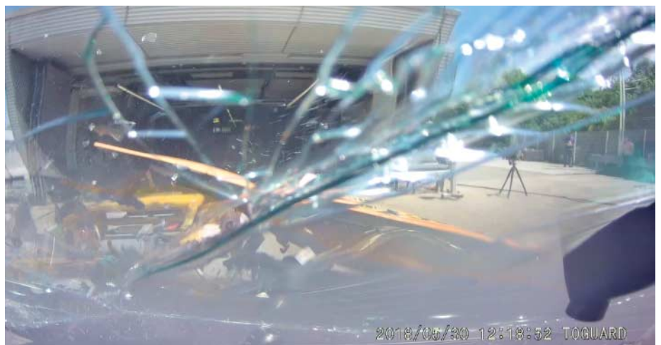
Im Moment des Crashes ändert sich alles: Millisekunden nach dem Aufprall beeinträchtigen die zersplitterte Frontscheibe und der Nebel explodierender Airbags die Sicht einer Dashcam. Immerhin gab die Kamerahalterung nicht nach.
