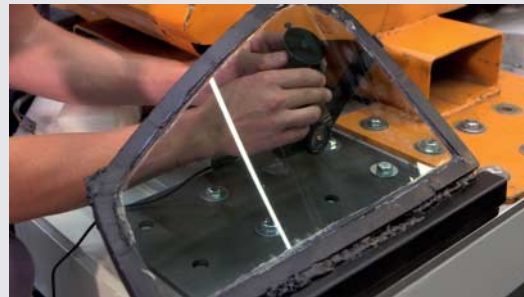
Die neun Testkandidaten fuhr der ADAC auf einem Schlitten kontrolliert gegen die Wand. Jede wurde an einer kleinen Windschutzscheibe montiert.
