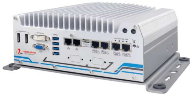
Der Nuvo-5608VR fährt in Bussen und Bahnen mit, um vor Ort die Bilder mobiler Überwachungskameras aufzuzeichnen.
