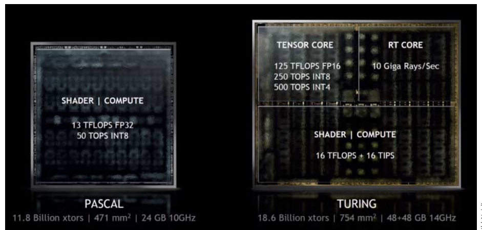
Der TU102-Chip überragt seinen Vorgänger nicht nur in der Rechenleistung, sondern auch in der Chipfläche (Abbildung symbolisch).
