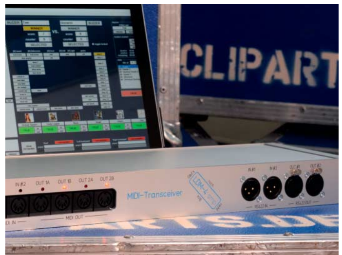
Midi ist nicht für den Transport über lange Leitungen gedacht. Es wird in RS-422 umgesetzt und symmetrisch übertragen.
