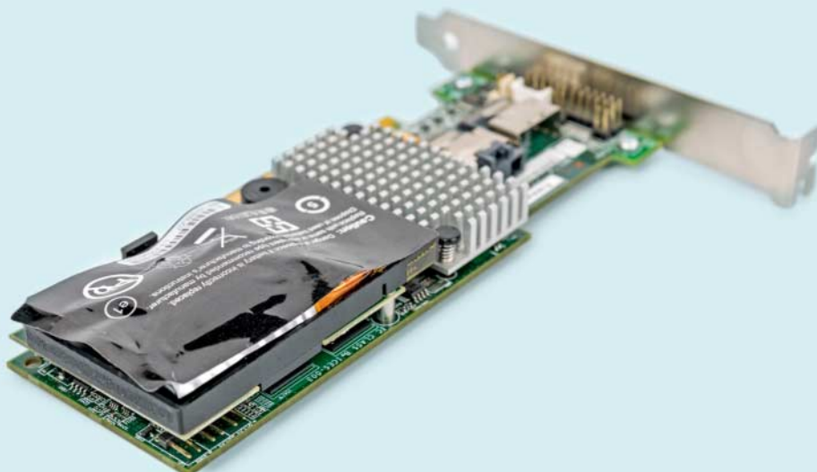
LSI MegaRAID SAS 9260-8i mit aufgequollenem Lithiumakku auf der Battery Backup Unit LSIiBBU07.
