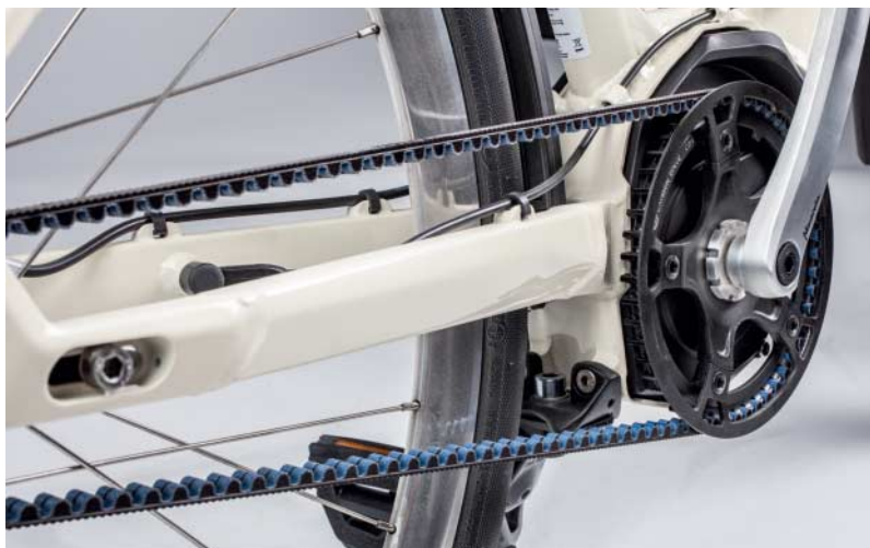
Ein Riemenantrieb verschleißt weniger als eine Kette. Viele Fahrer werden aber noch mehr zu schätzen wissen, dass kein Öl und Fett an der Hose landet.
