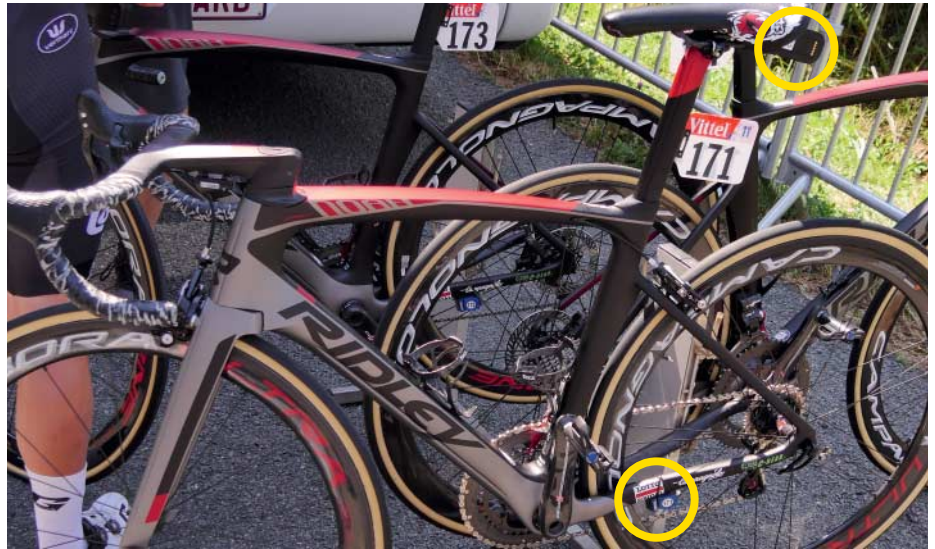
Die Räder tragen unterm Sattel Telemetriesender. Unten am Rahmen ist ein weiterer Transponder befestigt, der nur für die Zeiterfassung genutzt wird.
