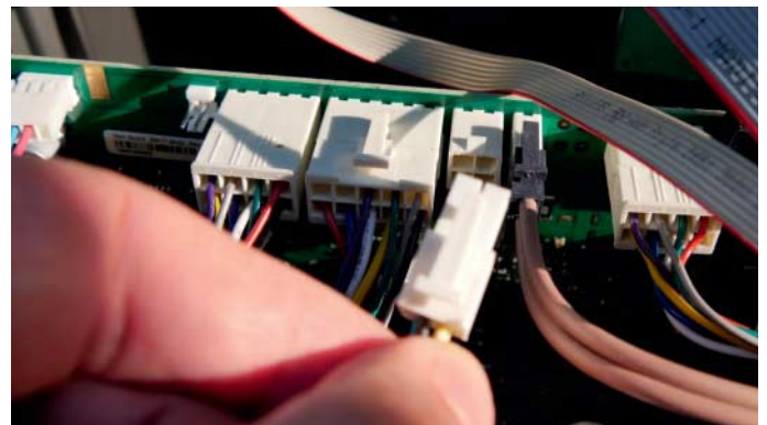
Vor dem Einsetzen des Robonect-Moduls muss man die Verbindung zum im Mäher integrierten Akku kappen, um die Steuerelektronik nicht zu beschädigen.
