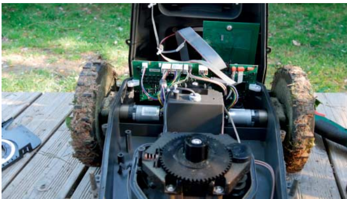
Sind alle Torx-Schrauben gelöst, lässt sich der Mähroboter leicht öffnen. Im hinteren Bereich liegt die Steuerelektronik, das Bedienfeld ist mit einem Flachbandkabel angeschlossen.
