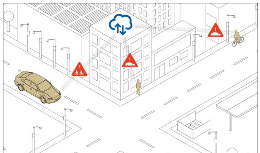
Das X2Safe-Konzept des Fahrzeugzulieferers ZF kombiniert Sensorik mit einem Algorithmus, der vor brenzligen Situationen warnt. Bei Fußgängern und Radfahrern sollen die Daten vom Smartphone per App gesammelt werden.
