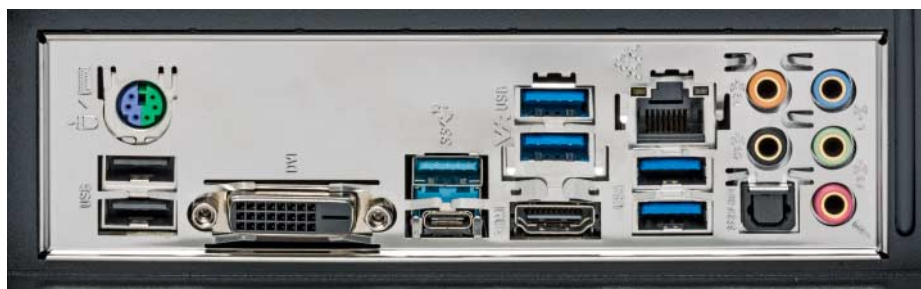
Die Farbe des USB-Isolators am PC verrät oft – aber nicht immer –, wozu sich der Port eignet: Schwarz markiert meist USB 2.0, blaue Buchsen übertragen als USB 3.1 Gen 1 bis zu 5 GBit/s, die türkise Buchse schafft 10 GBit/s brutto (USB 3.1 Gen 2).
