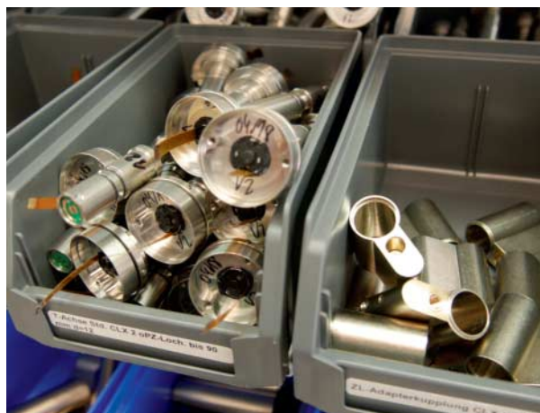
Feinmechanik trifft Elektronik: Beim Sicherheitsspezialisten Abus in Affing werden mechatronische Schließzylinder nach Kundenwunsch montiert.
