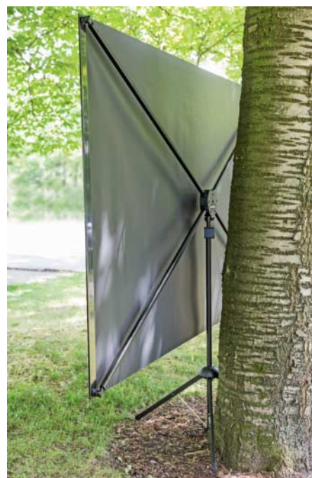
Kleine Federn am Ende der Vierkantrohre spannen das Projektionstuch auf; zusätzlich sicherten wir die Leinwand mit Schnüren gegen Wind.
