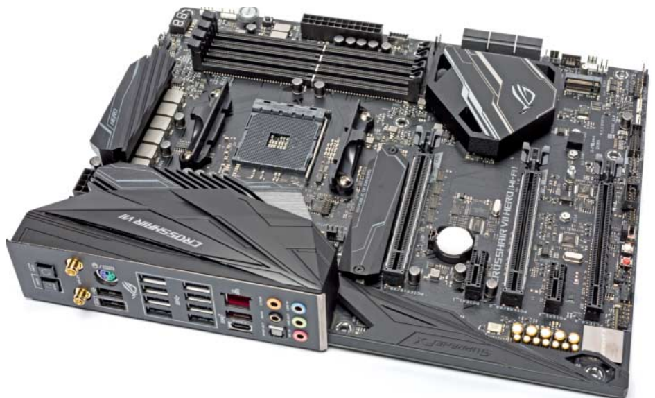
Der Chipsatz AMD X470, der auch auf dem Asus ROG Crosshair VII Hero sitzt, bringt nur kleine Verbesserungen im Vergleich zum X370.
