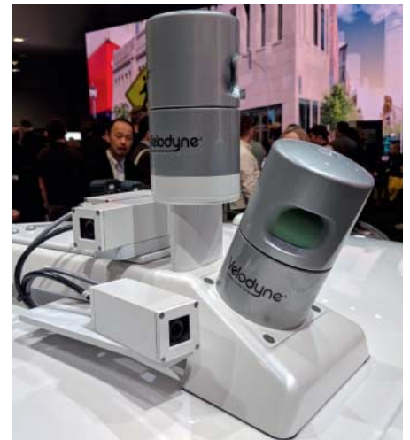
Die rotierenden Laserscanner sitzen bei Versuchsfahrzeugen derzeit noch als Fremdkörper auf dem Dach.
