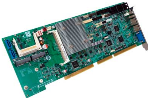
Die Steckkarte IEI WSB-BT passt auf PICMG-1.0-Backplanes für alte ISA-Erweiterungskarten.
