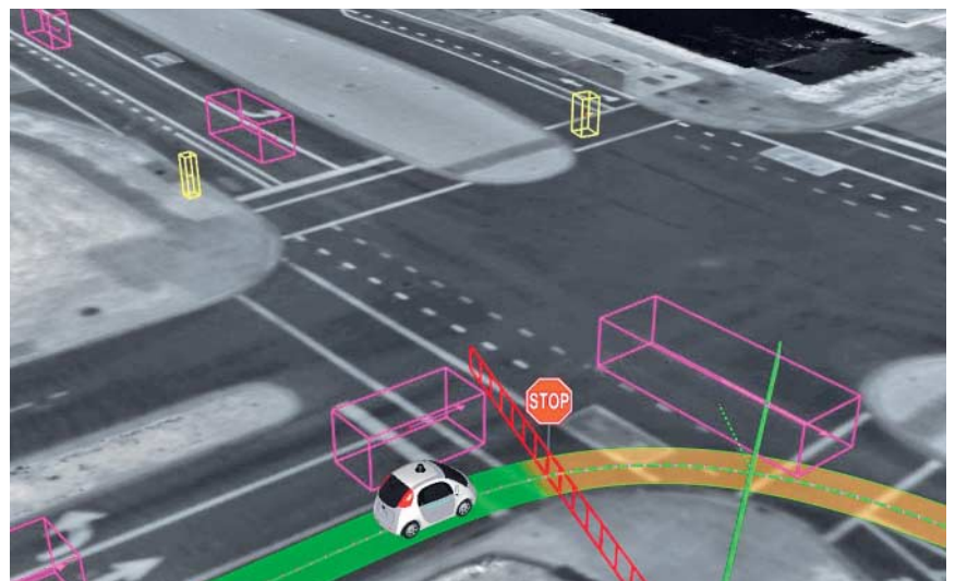
Aus den Sensordaten errechnen selbstfahrende Autos andere Fahrzeuge (pink), Fußgänger (gelb) und die Bedeutung von Verkehrsschildern (rot).
