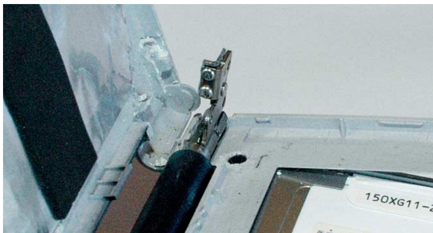
Ein im Laufe der Zeit immer schwergängigeres Notebook-Scharnier reißt beim Aufklappen seine allzu dünne Befestigung aus dem spröder gewordenen Kunststoffgehäuse des Rechners heraus. Eine Reparatur ist nahezu unmöglich.
