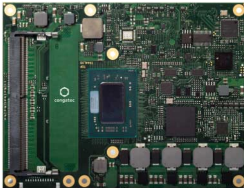
Auf dem Congatec conga-TR4 im COM-Express-Format sitzt ein AMD Ryzen Embedded V1000.
