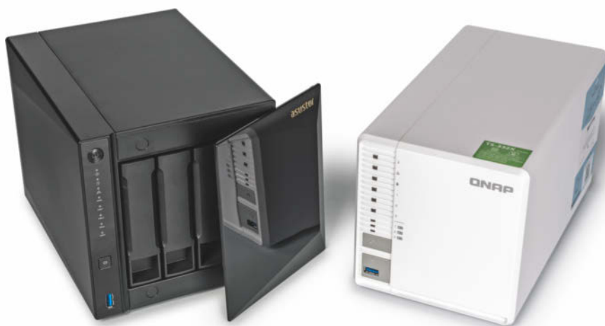
Beim Asustor AS4004T (links) lässt sich eine defekte Platte dank von außen zugänglicher Trays im Betrieb leicht tauschen. Das QNAP TS-332X muss man dazu aufschrauben.
