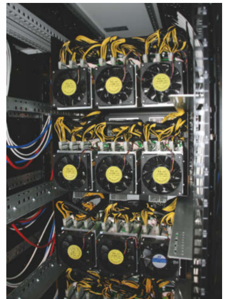
AntMiner der aktuellen Generation (hier neun in einem Server-Rack) berechnen Bitcoin-Hashes billionenfach schneller als CPUs in 2009. Die Difficulty sorgt dennoch dafür, dass nur alle zehn Minuten ein neuer Block entsteht.
