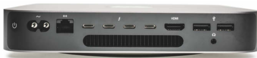
Hinten trägt der Mac mini 4 x Thunderbolt 3 (mit USB-C), zwei USB-3.0-Ports, HDMI 2.0, einen Ethernet-Anschluss und eine Kopfhörerbuchse.
