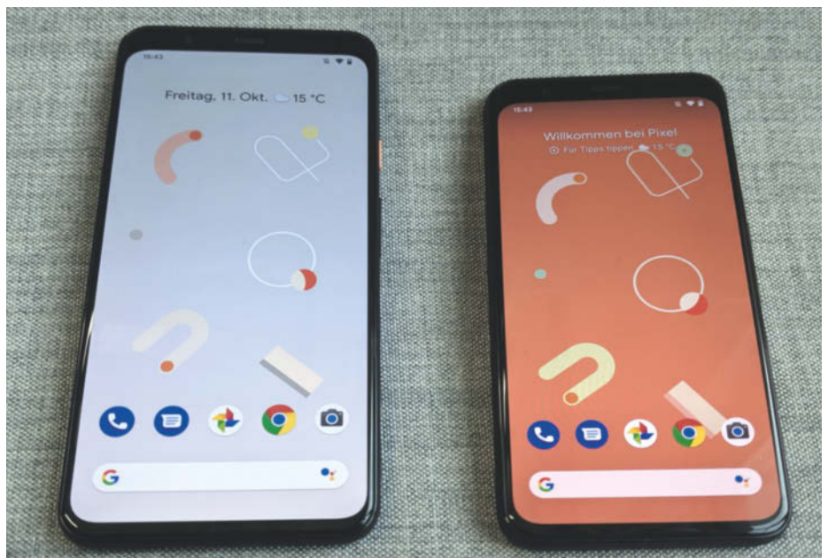
Seitlich und unten sind Display-Rahmen der Pixel-4-Phones ziemlich schmal, im oberen Rahmen steckt der Soli-Chip.
