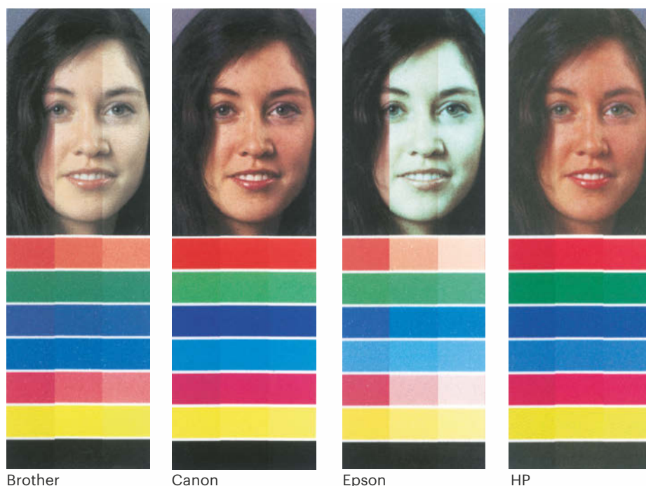
Auf Normalpapier blichen die Tinten von Brother mäßig, die von Epson stark aus (im Einzelbild von links nach rechts: 0, 100 und 200 Stunden im Tageslichtsimulator).
