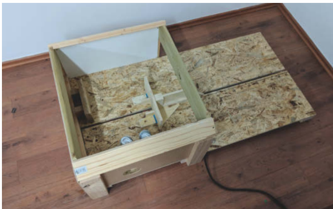
Im Keller baute IT-Fachmann Thiele eine Mini-Crash-Strecke auf, die das Scale-Car auf 25 km/h beschleunigte.
