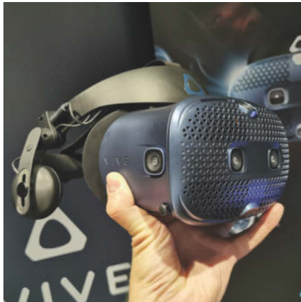
Die sechs eingebauten Tracking-Kameras der Vive Cosmos sind deutlich zu erkennen.
