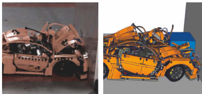
Anhand der Live-Aufnahmen vom Crash im Jahr 2017 wurde der virtuelle Crash-Verlauf überprüft und verbessert.
