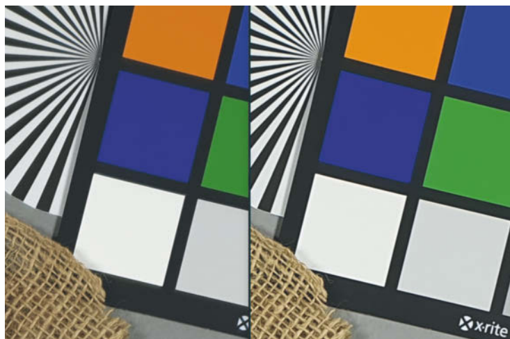
In puncto Rauschverhalten und Farbwiedergabe sind die alternativen Apps (links Footej) nicht so gut an den Sensor angepasst wie die Firmenlösungen (rechts Samsung).
