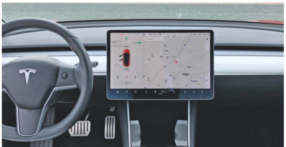
Aufgeräumt: Das Zentraldisplay ist die einzige Anzeige im Tesla Model 3. Es ersetzt fast alle Schalter und sogar den klassischen Tacho.
