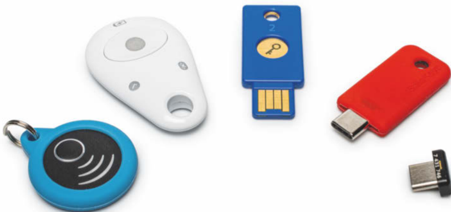
Am einfachsten geht FIDO2 mit einem kleinen Token für den Schlüsselbund. Das rote von Solo ist sogar komplett Open Source.
