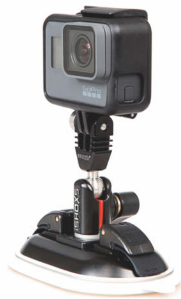
Mit dem ovalen Saugnapf und zwei kräftigen Hebeln zum Herstellen des Unterdrucks eignet sich der iShoxs Power Force Cup ProX für Kameras bis zu einem Kilogramm Gewicht. Der Hersteller legt aber ein Gummiband zur weiteren Absicherung mit in den Karton.
