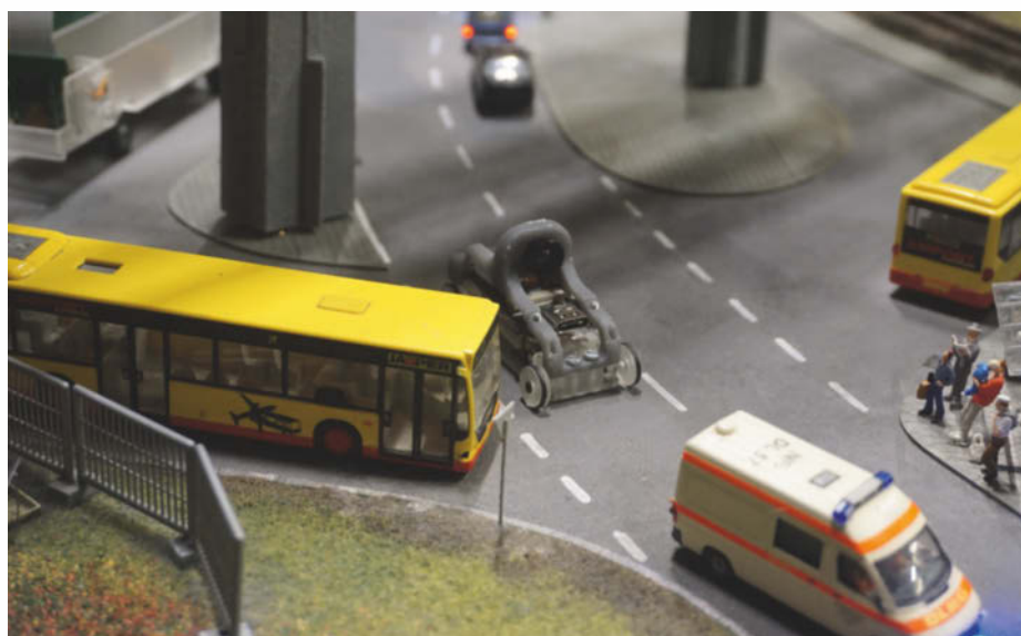
Visuelle Navigation im Maßstab 1 zu 87: Ein Minifahrzeug mit Raspi-Steuerung und Kameramodul zwischen Modellautos im Hamburger Miniatur-Wunderland.
