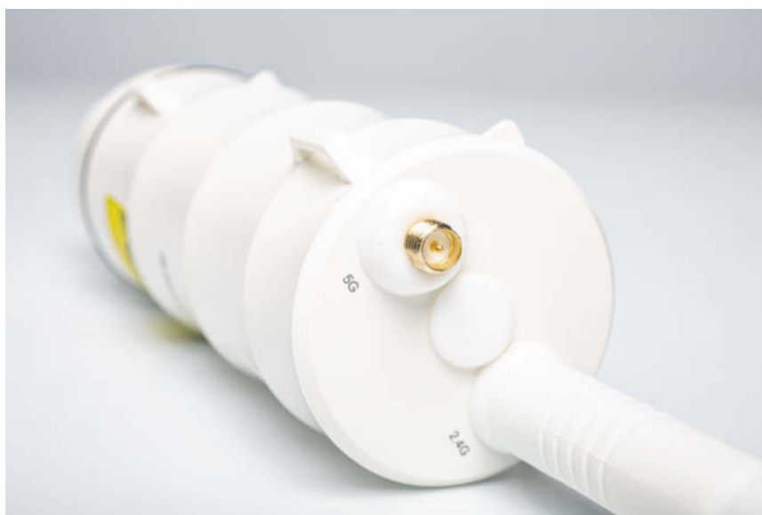
Die Antennenbuchsen der Outdoor-APs sind abgedichtet. Schrauben Sie die Antennen mit der Hand so fest, dass eine wulstige Dichtung wie hier nachgibt. Bei flachen Dichtungen soll der Kragen des Antennensteckers satt aufsitzen.
