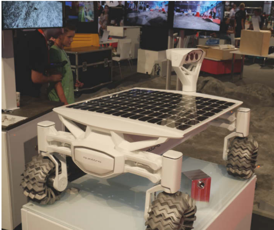
Ein Modell des Audi Lunar Quattro, wie er derzeit für den Einsatz auf dem Mond getestet wird. Rechts zwischen den Reifen steht der Kasten für das Lasermodul.
