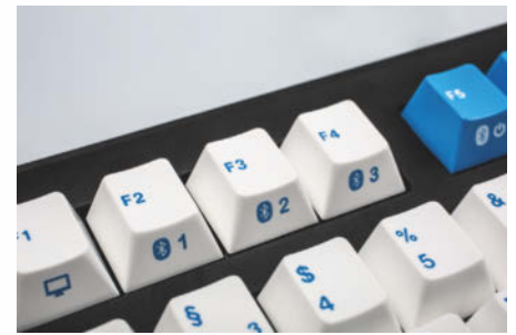
Das Uniqey-Keyboard hat Bluetooth an Bord. Bis zu drei Geräte koppelt man per Funk – nur mit dem Rechner muss man die Tastatur via USB verbinden.
