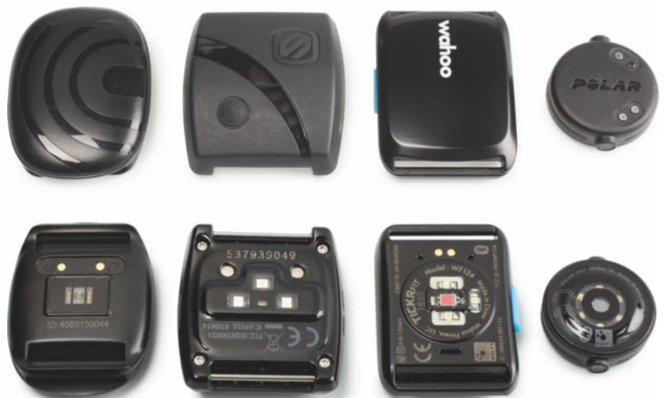
Blick auf die Vorder- und Rückseiten der getesteten Sensoren SmartLAB hrm A, Scosche Rhythm24, Wahoo TICKR Fit und Polar OH1+ (von links). Jeder Hersteller setzt bei den LEDs auf eine andere Anzahl, Farbe beziehungsweise Anordnung.
