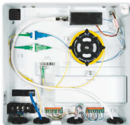
Der Micro-DSLAM Keymile MileGate 2042 transportiert über 50 Meter Telefonleitung mindestens 1,5 GBit/s (Down- plus Upstream) aus dem Gebäudekeller in die Kundenwohnung und speist optional Kabel-TV-Signale ein.
