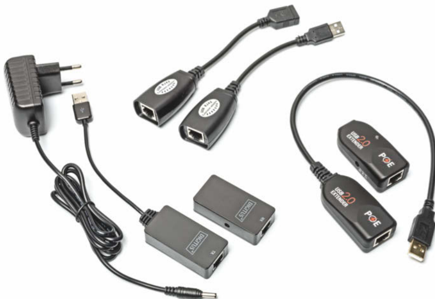
USB-Brücke über Ethernet: Damit lässt sich eine Fritzbox im Keller leicht mit einem Mobilfunkstick unterm Dach verbinden. Aber nicht jede Brücke funktionierte im Test und schon gar nicht jede mit jedem Stick (links: Digitus, Oben: 2-Tech, rechts: LogiLink).
