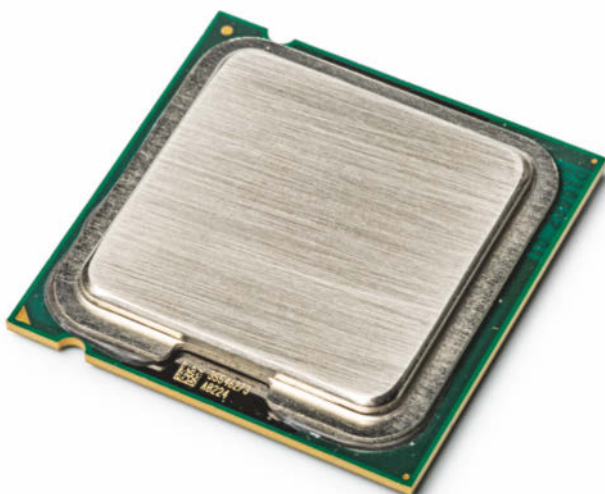
Die alte eingelaserte Beschriftung wurde sorgfältig abgeschliffen. Die abweichende Heatspreader-Form und der Produktcode unten identifizieren die CPU aber als Uralt-Sockel-775-Model.
