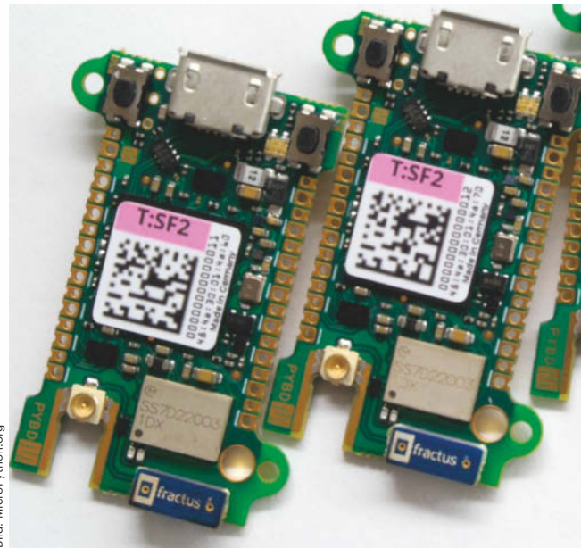
Das Pyboard-D mit STM32F7-Controller und WLAN lässt sich in Python programmieren.
