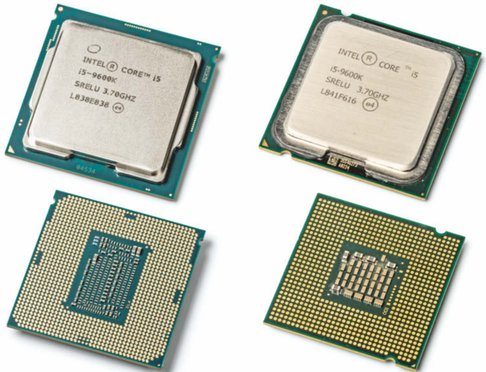
Links das Original, rechts die manipulierte CPU. Von oben ist der Unterschied nur im direkten Vergleich zu erkennen. Ein Blick auf die CPU-Unterseite macht dann aber sofort klar, dass hier ein Prozessor mit deutlich weniger Anschlüssen manipuliert wurde.
