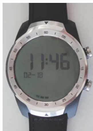
Die Ticwatch Pro hat zwei Displays übereinander: Das LCD-Display reicht zum Ablesen der Uhrzeit.
