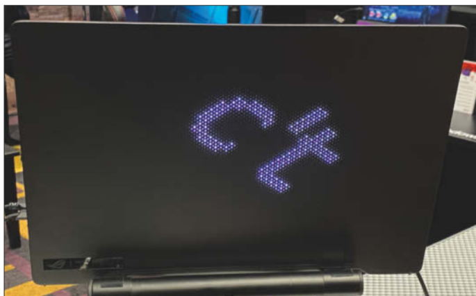
Das Zephyrus G14 von Asus ist nicht nur wegen der Kombination aus Ryzen 4000 und GeForce-GPU interessant: Die Deckelaußenseite enthält eine frei ansteuerbare LED-Matrix.
