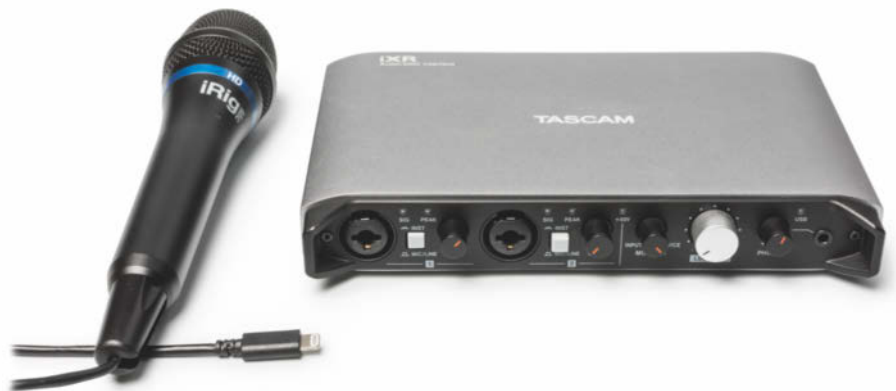
An iOS-Geräte lassen sich auch Mikrofone mit Lightning-Anschluss (hier ein iRig Mic HD 2 von iK Multimedia) sowie USB-Audio-Interfaces (hier ein Tascam iXR) anschließen.
