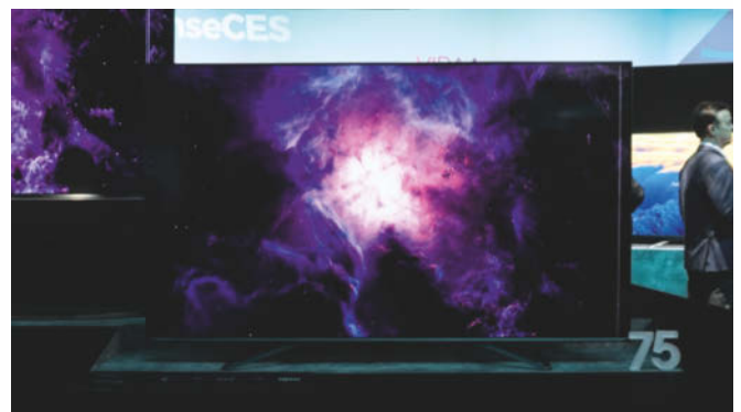
In den Dual-Cell-ULED-TVs von Hisense sorgt das hintere LC-Panel mit 2 Millionen Dimming-Zonen für hohe Kontraste.
