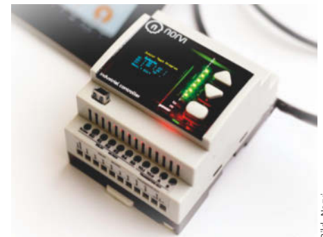
Der Norvi IIOT ist ein kompaktes ESP32-Steuersystem.
