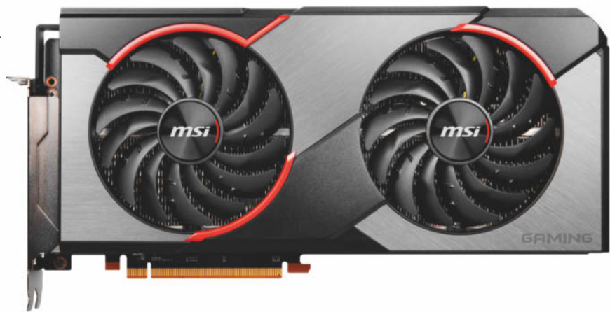
MSI verwendet auf der Radeon RX 5600 XT ein Doppellüftersystem, andere Hersteller statuen sie mit drei Ventilatoren aus.
