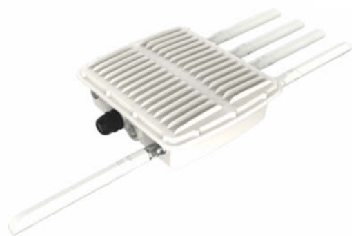
Das Gateway Ursalink UG87 kann bis zu 16 LoRaWAN-Kanäle gleichzeitig empfangen und per LAN, WLAN und Mobilfunk ins Internet leiten.
