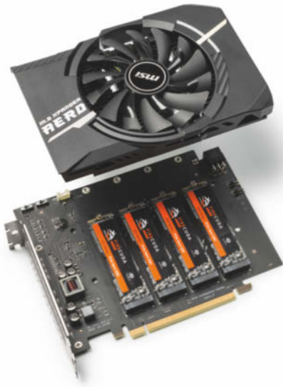
Die MSI-Karte M.2 Xpander Aero nimmt vier schnelle PCIe-SSDs auf – gut gekühlt und dazu noch aktiv belüftet.
