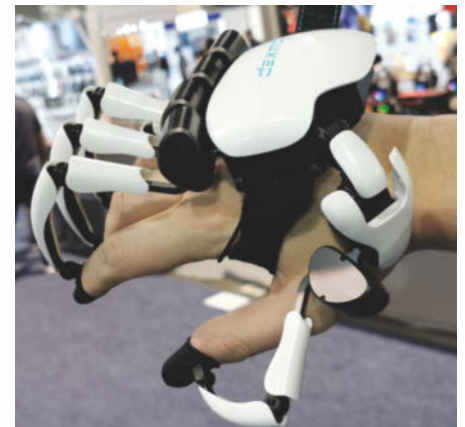
Die Handschuhe von Dexmo vermitteln virtuelle Berührungen per Exoskelett.
