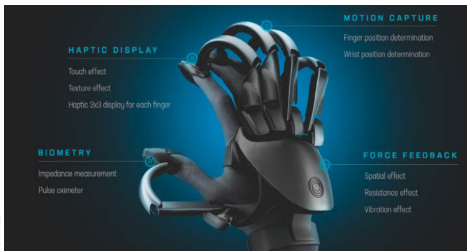
Der Teslasuit Glove kann eine Kraft von 1 bis 10 Newton ausüben.
