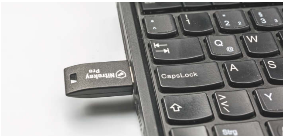
Der mitgelieferte Nitrokey überprüft, ob der Bootcode manipuliert wurde.
