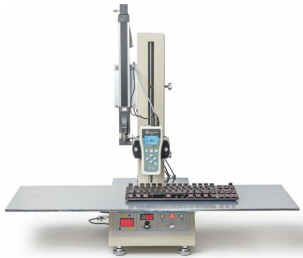
Auf diesem selbst entwickelten Prüfstand vermessen wir den Druckpunkt von Tastaturen.
