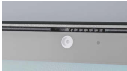
Beide Testkandidaten haben eine 720p-Webcam, deren Linse sich mit einer mechanischen Blende verschließen lässt, um versehentliche Aufnahmen zu verhindern (links: Lenovo, rechts: HP).
