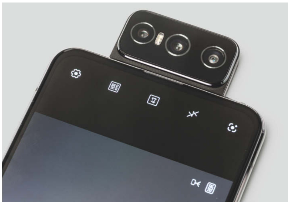
Die Klappkamera des Asus Zenfone 7 Pro ist Haupt- und Selfiecamera zugleich.
