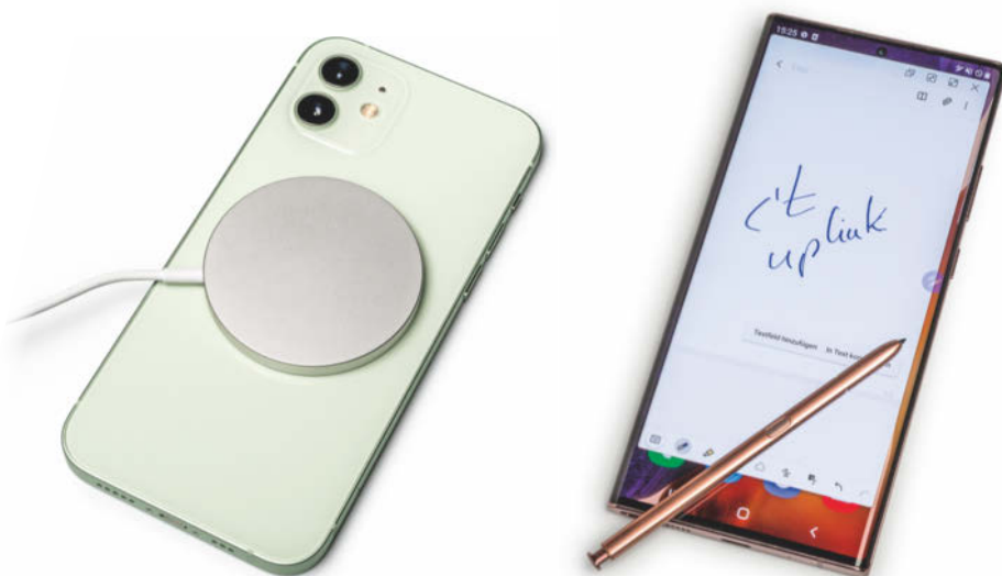
Apples MagSafe-Ladegerät dockt magnetisch am iPhone 12 Pro und lädt den Akku via Induktion.
