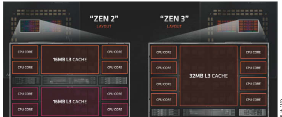
Die Organisation der Recheneinheiten innerhalb des CCD-Chiplets ermöglicht einen großen Teil der Extra-Performance beim Ryzen 5000.
