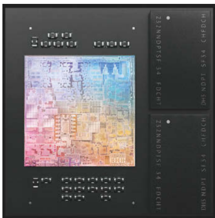
Mit 16 Milliarden Transistoren gegen Intel: Apple schickt den M1 mit vier starken und vier effizienteren ARM-Kernen ins Rennen. Auch das RAM (rechts) sitzt beim M1 auf dem CPU-Package.
