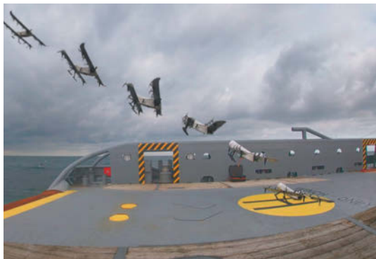
Die neue Wasserstoffdrohne ist ein Senkrechtstarter mit Treibstoff für viele Stunden über der offenen See.
