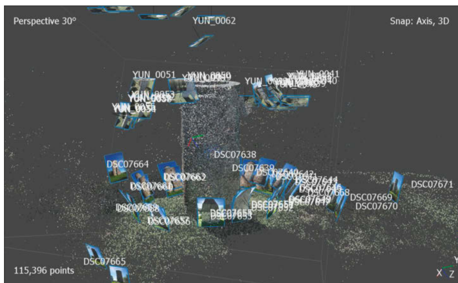
Beim Ausrichten wird die Position und die Orientierung der Kamera in allen Fotos bestimmt.
