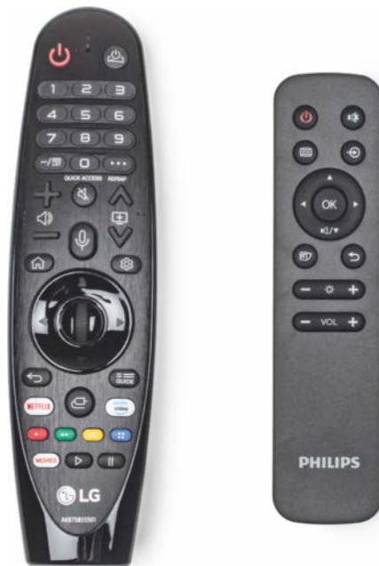
Philips (rechts) transponiert die Steuerkreuz-Bedienung des Bildmenüs auf die Fernbedienung. Mit eingebautem Gyroskop lenkt man bei LG alternativ einen Zeiger über den Schirm.
