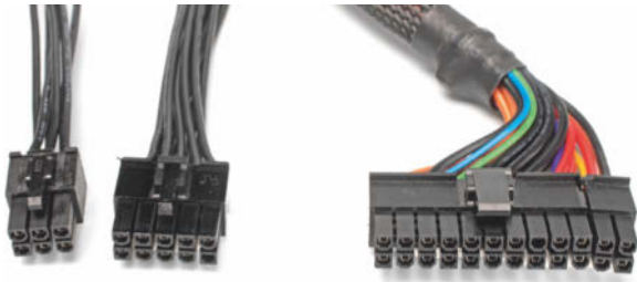
Der bisherige 24-polige Mainboard-Stromstecker (rechts) schrumpft bei ATX12VO auf 10 Kontakte sowie einen 6-poligen PEG-Stecker zusammen.
