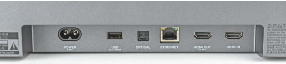
Über den USB-Anschluss auf der Rückseite lassen sich bei der US-Version MP3-Dateien von Speichermedien abspielen. Bei der deutschen Ausführung dient er hingegen nur Servicezwecken.
