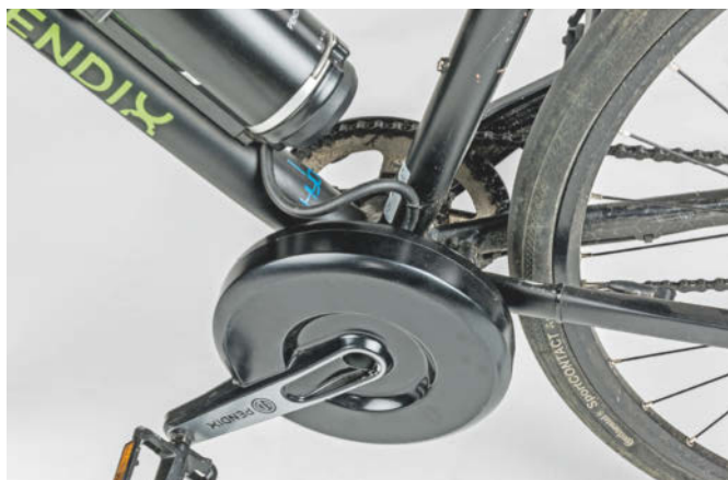
Der Pendix-Motor sitzt an der linken Tretkurbel und passt an die meisten Fahrradrahmen.
