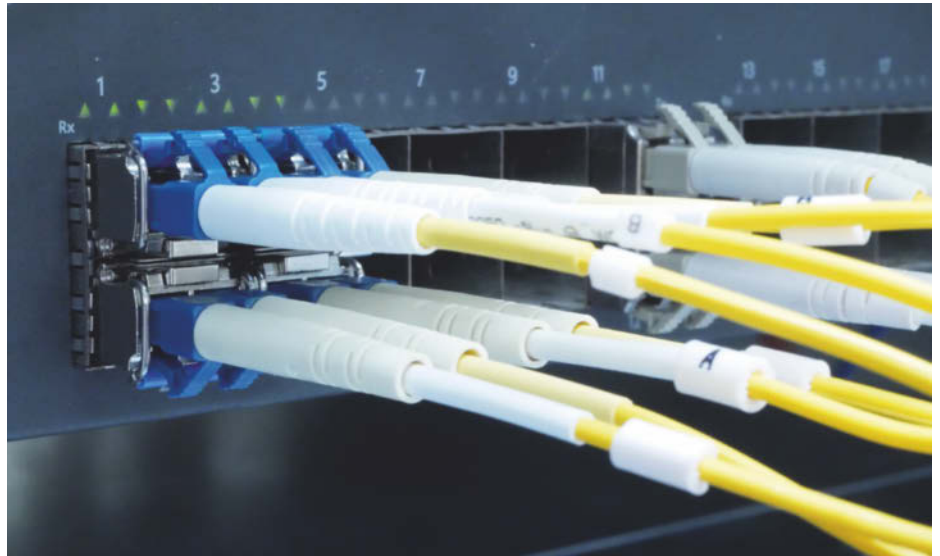
Singlemode-SFP-Module übertragen 1 GBit/s auch über große Distanzen.
