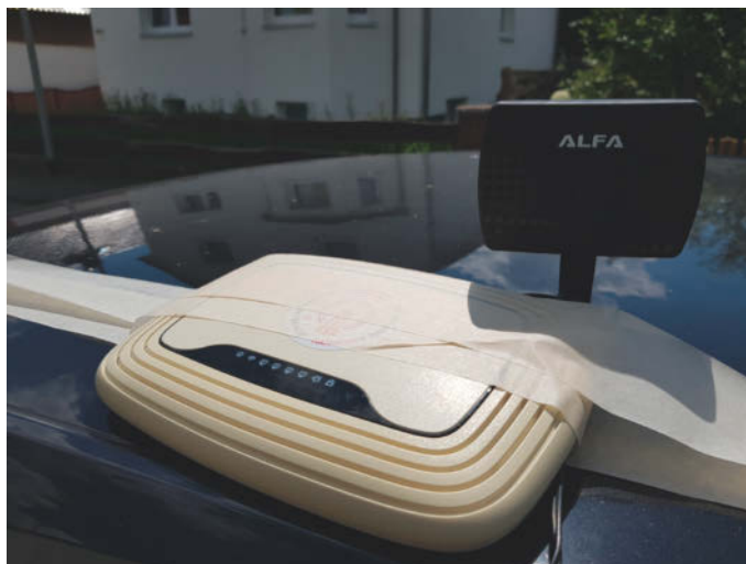
Per WR841ND-Router mit weiter Richtantenne auf dem Dach eines Autos kann man einen Häuserblock oder eine große Freifläche absuchen.
