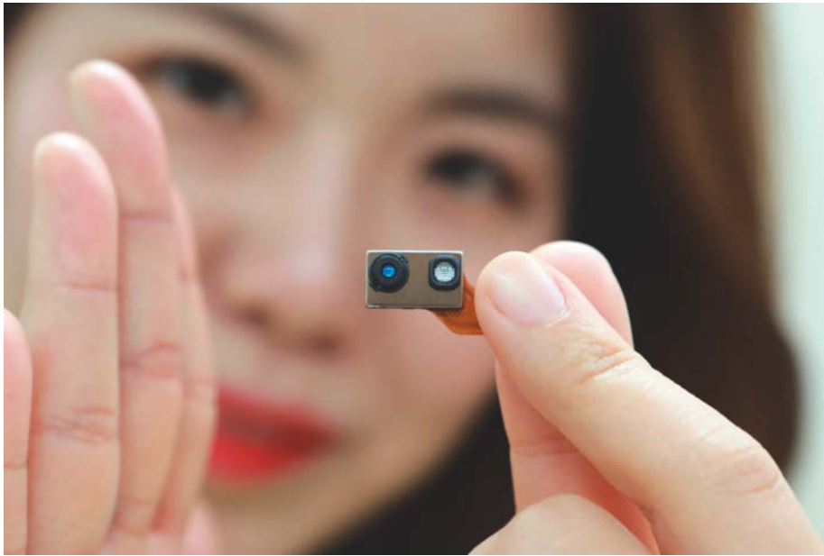
Ein typisches ToF-Kameramodul fürs Smartphone, hier von LG Innotek.
