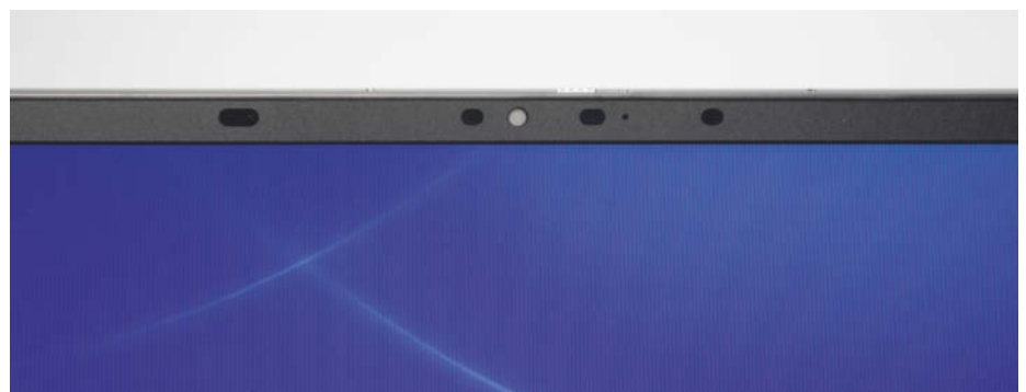
Im Bildschirmrahmen des Dell Latitude 9510 befindet sich außer einer Hello-tauglichen Webcam auch ein Näherungssensor, der das Notebook automatisch sperrt, wenn man aufsteht und wegläuft.
