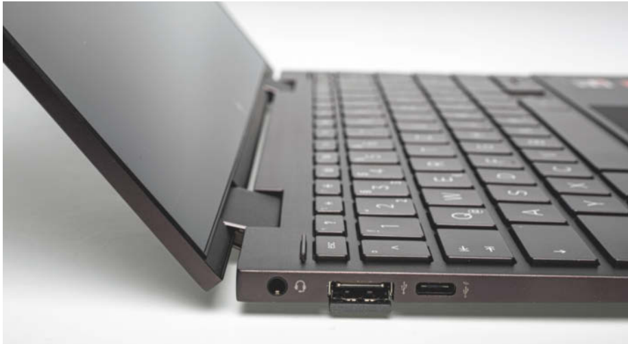
Der Rumpf des HP Envy x360 13 (ay0) ist dermaßen flach, dass die USB-A-Buchsen nur mit ausklappbarem „Unterkiefer“ realisiert werden konnten.
