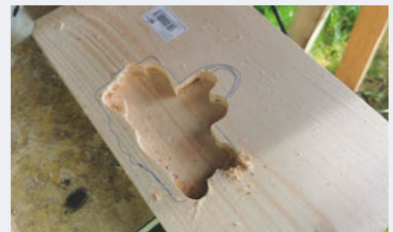
Mit der Oberfräse arbeitet man sich vorsichtig an die Markierung heran.
