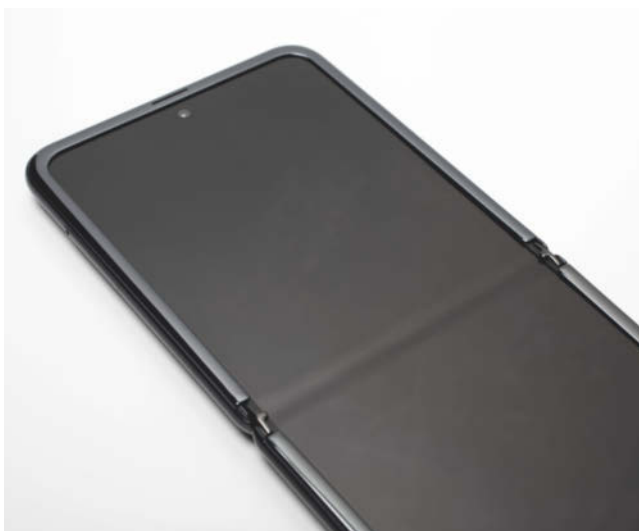
Das faltbare Display des Samsung Galaxy Z Flip soll robuster sein als das des Galaxy Fold 5G. Bei beiden ist im ausgeklappten Zustand immer eine Kerbe im Display sichtbar. Unter dieser liegt das Gelenk.
