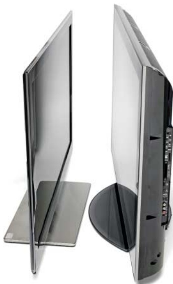
Fernseher mit Edge-LED-Backlight eignen sich besser für die Wandmontage als die deutlich dickeren Geräte mit Full-LED-Backlight.
