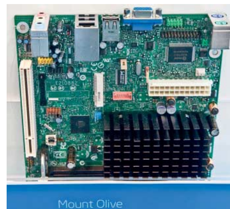
Mini-ITX-Boards sind typische Untersätze für Atom D410 und D510.
