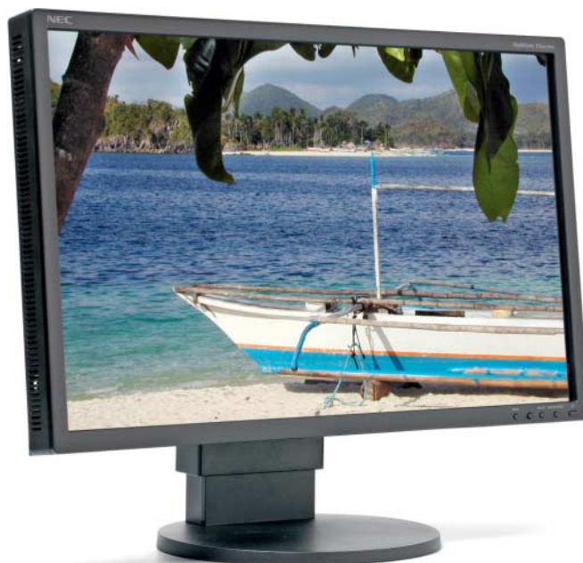
NEC EA261WM: Der 26-Zöller wartet mit einem großen Farbraum auf, hat aber Schwächen bei der Graustufenauflösung.
