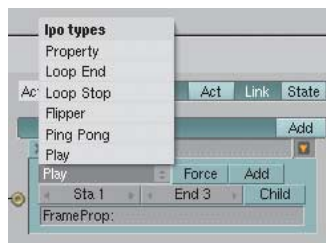
Von den zahlreichen Betriebsarten des IPO-Actuators ist für die Flipperhebel natürlich der Flippermodus ideal.
