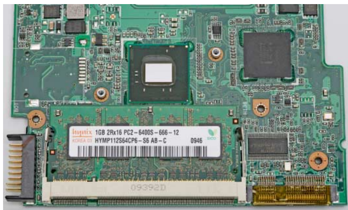
Das kleine Die des Atom N450 (Bildmitte) enthält einen Speicher-Controller und die Grafikeinheit GMA 3150. Der Chipsatz besteht nur aus dem I/O-Baustein NM10 (rechts oben).
