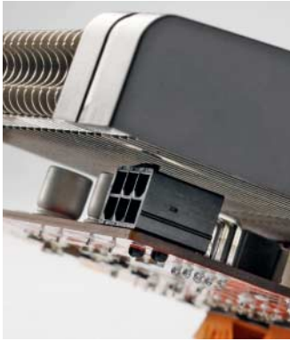
Scharfe Kühlrippen überdecken den sechspoligen Stromanschluss der PowerColor Radeon HD 5750 SCS3, das Abziehen gerät zur gefährlichen Angelegenheit.
