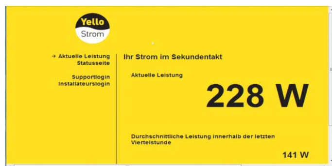
Der integrierte Webserver im Stromzähler von Yello Strom produziert eine HTML-Seite mit dem im Sekundentakt aufgefrischten Messwert.
