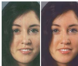
Das Advanced-Papier (rechts) schützt die Drucke des Office- jet 6000 vor dem Sonnenlicht.
