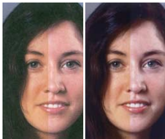
Die Farben des Pixma iP2600 geben unter Lichteinfluss sichtbar nach.
