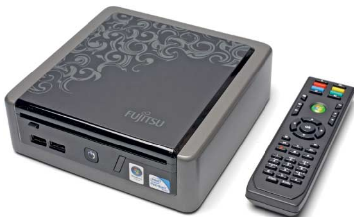
In kompakte Media-Center-PCs wie Fujitsus Esprimo Q1500 passen keine Steckkarten, sodass man (weitere) TV-Empfänger extern anschließen muss.
