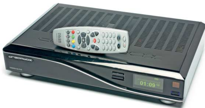
Einer der wenigen DVB-Recorder, deren Kartenleser sich umprogrammieren lässt, um mit einer gültigen Abokarte Sky aufzuzeichnen, ist die Dreambox DM8000 HD PVR.
