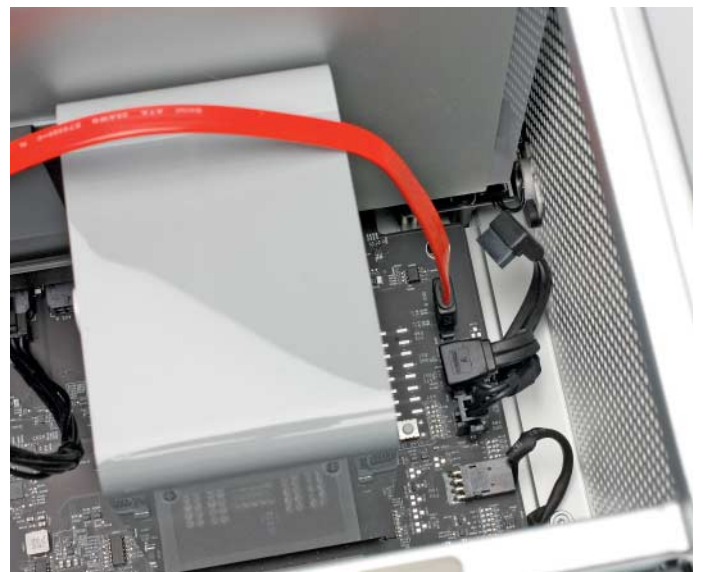
Im aktuellen Mac Pro kann man das Kabel für das zweite DVD-Laufwerk abklemmen und durch eines für eSATA ersetzen.
