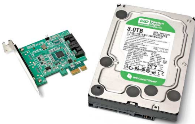
Die erste 3-TByte-Festplatte mit Serial-ATA-Schnittstelle von Western Digital eignet sich für den Einsatz als Zweitlaufwerk im PC. Der mitgelieferte Hostadapter hilft beim Sprung über die 2-TByte-Grenze.
